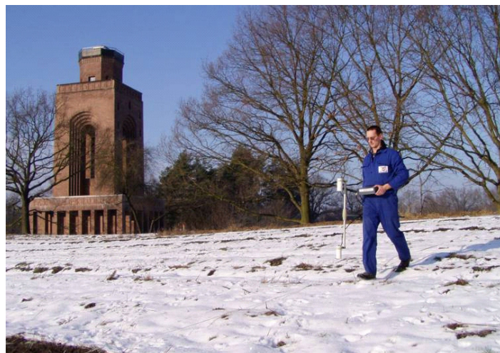
Messung mit optisch gepumpten Cäsiummagnetometer
