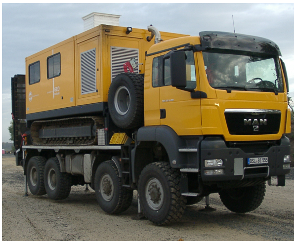
Sondierdraupe auf LKW
